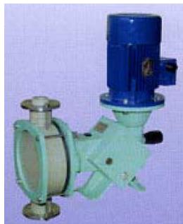
La elettropompa MA 180 è un modello di pompa volumetrica a membrana diretta. La membrana è mossa meccanicamente da un movimento di reciprocazione che opera in un carter a bagno d'olio unitamente a una coppia di riduzione di velocità a vite senza fine, entrambi azionati da un motore elettrico.
