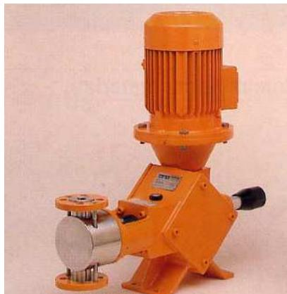
Le elettropompe serie M25-35 sono pompe volumetriche a pistone tuffante. I pistoni sono realizzati nei materiali piu' resistenti meccanicamente e chimicamente (ceramica e acciaio INOX) e sono mossi da un movimento di reciprocazione che opera in un carter a bagno d'olio unitamente a una coppia di riduzione di velocità a vite senza fine, entrambi azionati da un motore elettrico.
